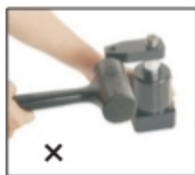
不正確拆壓板
